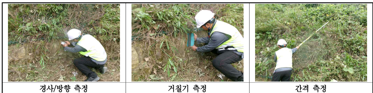
【사진 27.3.2】 불연속면 측정 현황
